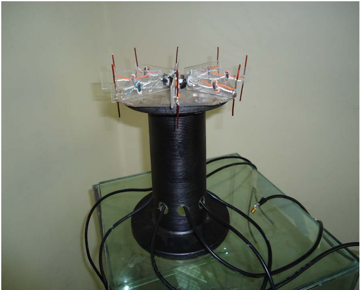
Fig 4.1 8 Dipole array antenna
