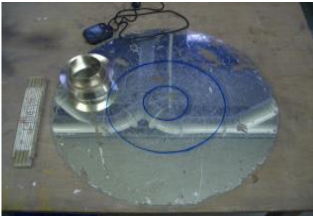
Fig 4.8 (a): Hagermans Mini Cone Flow Apparatus (Rizwan 2006)
