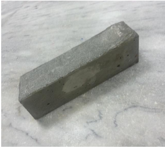
Figure 3-13: Demoulded Prisms (EN 196-1)
