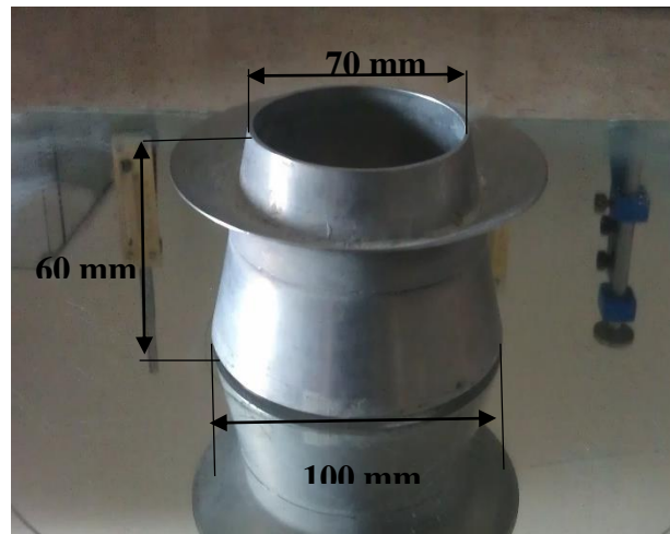
Figure 3-4: Hagerman's mini slump cone 7 \times 7 \times 10 \text{ cm}^3
