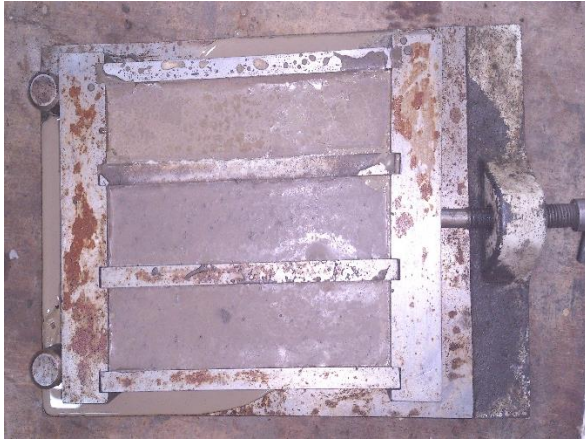
Figure 3-11: 4x4x16 cm 3 Prisms for SCP and SCC (EN 196-1)
