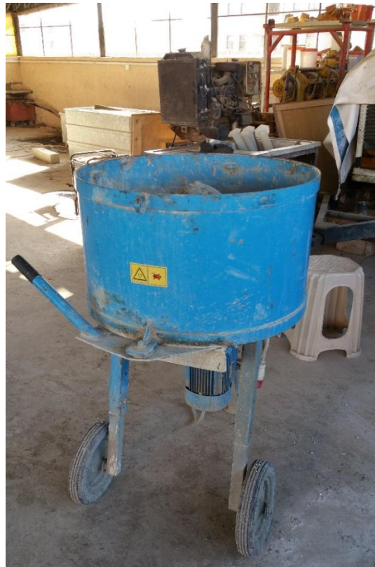
Fig. 3.4. Horizontal concrete mixer
