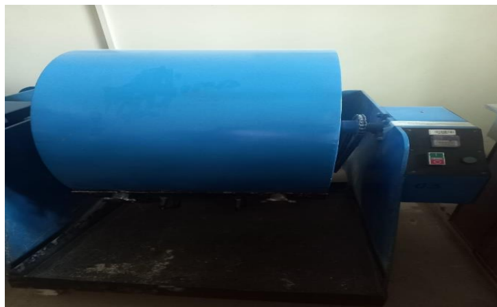
Fig 3.5 Apparatus for LOS Angles
