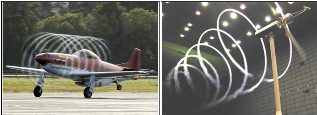
(d) Smoke visualization of wingtip vortices from a Wind Turbine experiment (Chattot, 2007)
