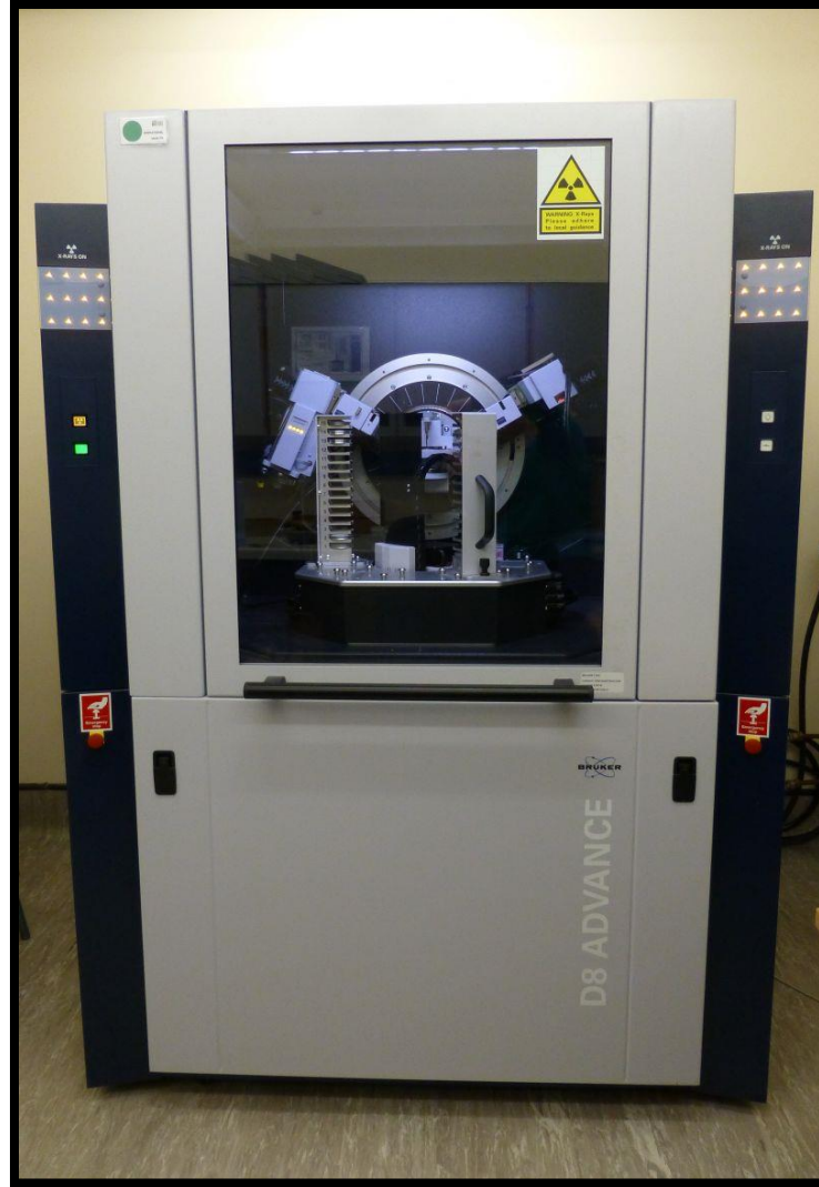
Fig 3.1) D8 Advance XRD Machine
