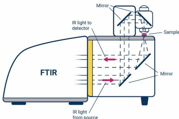
**Figure 3. 5:** FTIR apparatus
