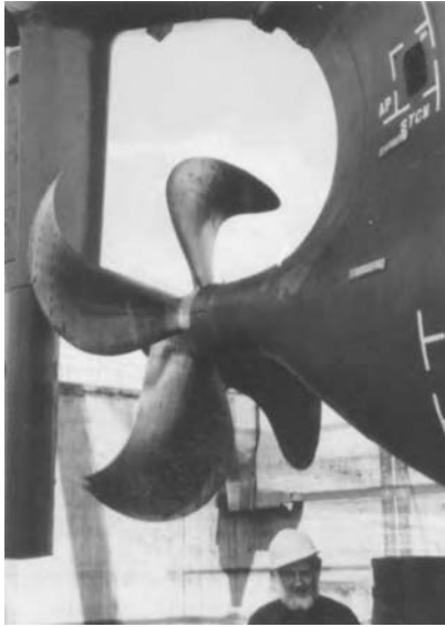
Fig. 22.6 The Kappel propeller.
