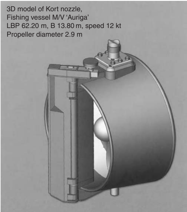
Fig. 21.12 Becker Kort steering nozzle.
