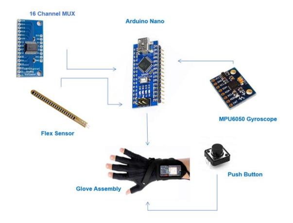
**GESTURE CONTROLLED DRONE BLOCK DIAGRAM**
